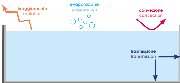
Fig 1: Dispersioni termiche di una piscina
