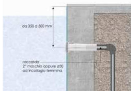
MLAZNICA SA ZIDNIM PRODOROM C-27 RETURN FITTING C-27
