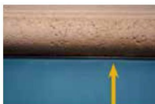
Nikakav vidljivi var, nikakva razlika u boji No visible weld, no colour difference
